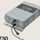
AH-730 Deckt den Frequenzbereich von 1,8 bis 54 MHz mit einer mindestens 7 m langen Drahtantenne ab.
