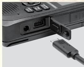
Das ID-52E PLUS verfügt über einen in der Branche gängigen USB Type-C™-Anschluss, der das Aufladen, die Programmierung über einen PC, das Lesen und Schreiben von Daten auf eine Micro-SD-Karte, die Kompatibilität mit dem Terminal/Access-Point-Modus und die CI-V-Steuerung gewährleistet.
