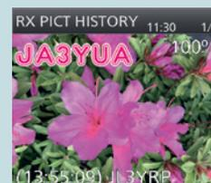
Bilder lassen sich mit anderen Funkamateuren teilen und können auf dem Farbdisplay betrachtet werden. Mit einem Smartphone aufgenommene Bilder kann man über Bluetooth® drahtlos auf das ID-52E PLUS übertragen.
