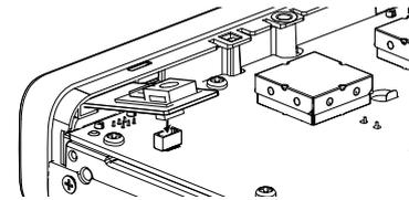
5. Halterung der UT-133A aufsetzen und wieder festschrauben.
