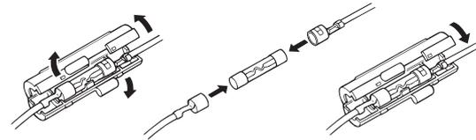
**⚠ WARNUNG! NIEMALS** das Kabel kürzen, um es ohne Sicherungshalter zu verwenden. **UNBEDINGT** Sicherungen mit dem vorgegebenen Nennwert als Ersatz verwenden.
