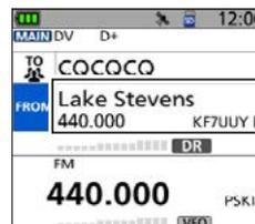
4. Wenn das Handfunkgerät ein Signal von einem Repeater empfängt, stoppt der Suchlauf. [SCAN] drücken.
