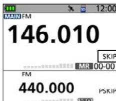
Wenn ein Kanal als Übersprungkanal markiert ist, wird „SKIP“ oder „PSKIP“ angezeigt.
