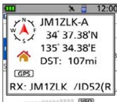
Wenn das Signal empfangen wird, werden die enthaltenen Positionsinformationen im RX-Positionsfenster angezeigt.
