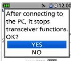
**HINWEIS:** Bevor man das Handfunkgerät im SD-Kartenmodus mittels USB-Kabel an einen PC anschließt, muss eine Micro-SD-Karte eingesetzt werden.
