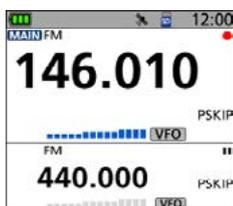
Die Aufzeichnung beginnt, wenn man sendet oder der Squelch geöffnet wird. Während der Aufnahme blinkt das SD-Kartensymbol.
