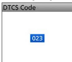
① Die wählbaren DTCS-Codes liegen zwischen 023 and 754.
