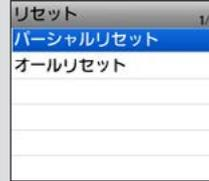
① **NICHT** den unteren Menüpunkt wählen! Er bewirkt einen Total-Reset, bei dem alle Eingaben gelöscht und alle Einstellungen auf die Werkseinstellung zurückgesetzt werden.
