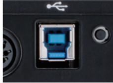
USB-Anschluss an der HF-Einheit (USB-3.0-Kabel erforderlich)
