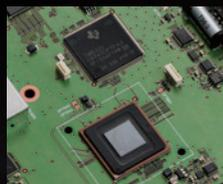
DSP + FPGA (HF-Einheit)
