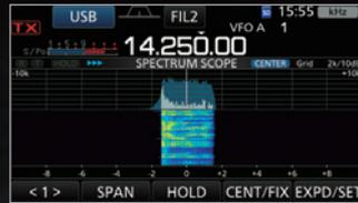
DPD EIN (Signal mit einem IC-7300 empfangen) keine Nebenausstrahlungen erkennbar
