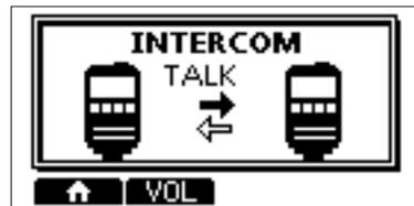
**HINWEIS:** Während des Intercom-Betriebs sind die Sende- und Empfangsfunktionen des Funkgeräts abgeschaltet. Während des Sendens mit dem Funkgerät steht die Intercom-Funktion nicht zur Verfügung.
