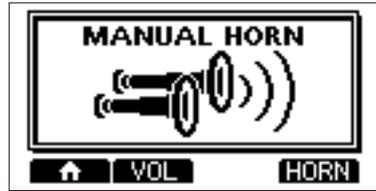
**HINWEIS:** Während der Nutzung des Nebelhorns sind die Sende- und Empfangsfunktionen des Funkgeräts abgeschaltet. Während des Sendens mit dem Funkgerät steht die Nebelhorn-Funktion nicht zur Verfügung.
