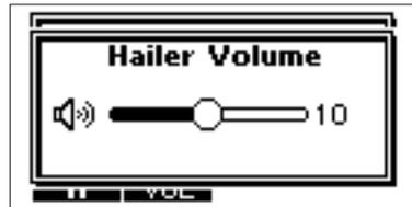
**HINWEIS:** Während des Megafon-Modus sind die Sendefunktion und die Empfangsfunktion des Funkgeräts abgeschaltet. Während des Sendens mit dem Funkgerät steht die Megafon-Funktion nicht zur Verfügung.
