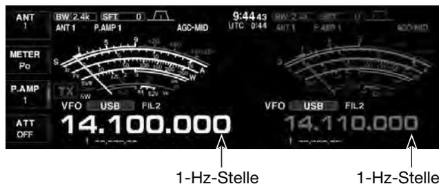
**HINWEIS:** Die Abstimmung in 1-Hz-Schritten wird für Haupt- und Subband gleichzeitig ein- oder ausgeschaltet. Daher kann man beide [TS]-Tasten nutzen.
