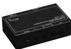
Zur Fernsteuerung des Transceivers mit einem PC. Frequenzen, Betriebsarten, Speicherkanäle usw. lassen sich steuern. (Software nicht im Lieferumfang)
