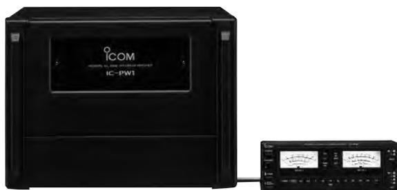
Dauerlastfeste 1-kW-Linearendstufe mit eingebautem automatischen Antennentuner. Bei Nutzung mit Icom-Transceivern automatisch abstimmend und automatische Bandumschaltung. Voll-QSK-fähig. Bedienteil separat von der Verstärker-/Netzteil-Einheit.
