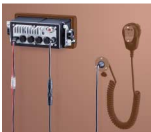
Installationsbeispiel an transparenter Montagefläche, von hinten gesehen
