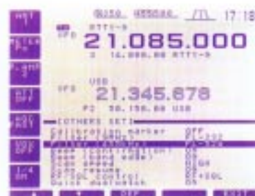
[Bild 3] Set-Modus-1 Grundeinstellung wie z. B. die Kalibrierung, optionale Filtereinstellungen, Quitzungston und Suchlaufgeschwindigkeit können hier eingestellt werden.
