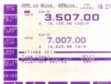
[Bild 7] Timer-Einstellungen In diesem Bildschirm werden die Einstellungen und Parameter für die Timer-Funktionen wie z. B. automatische Ein- und Ausschaltzeit durchgeführt.
