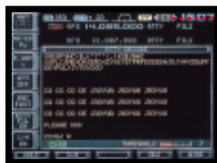
Textdarstellung bei der Dekodierung eines RTTY-Signals.
