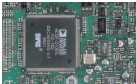
DSP-Einheit beweisen unter anderem die leistungsfähigen digitalen ZF-Filter, die jeglichen Verzicht auf die Nachrüstung zusätzlicher konventioneller Schmal- bzw. Breitbandfilter erlauben.
