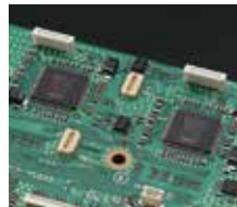
Sende/Empfänger-DPS (links) und Empfänger-DSP (rechts) ADSP-21489 von Analog Devices 32-Bit-Fließkomma-DSP 2400 MFLOPS 393 MHz Takt
