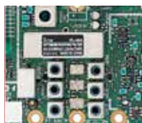
1,2-kHz-Optimum-Roofing-Filter in der 1. ZF und die anderen mit 3, 6, 15 kHz Bandbreite
