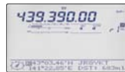
▲Richtung und Entfernung der empfangenen Station
